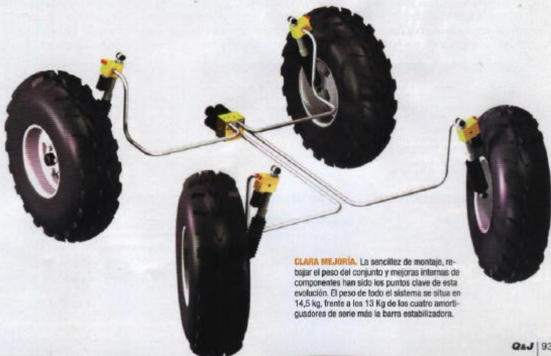
LOS CILINDROS han visto variado su diseño tanto interior como exterior. Ahora resultan considerablemente menos pesados que los elementos utilizados con anterioridad.
