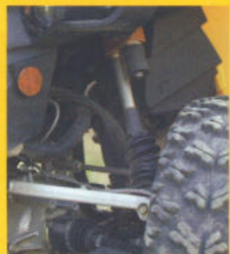
LOS AMORTIGUADORES están unidos a una centralita común con cuatro pistones que forma un circuito cerrado de aire a presión.
