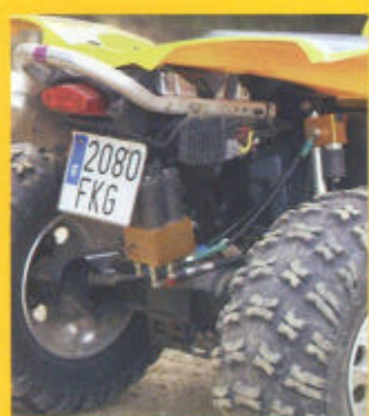
LOS AMORTIGUADORES están unidos a una centralita común con cuatro pistones que forma un circuito cerrado de aire a presión.
