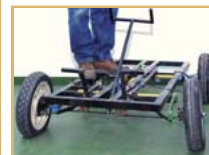
Funciona igual que la variante hidráulica analizada, aunque con muelles y barras de torsión. Es aplicable a algunos 4x4, entre ellos el Range.
