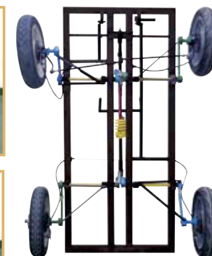
Funciona igual que la variante hidráulica analizada, aunque con muelles y barras de torsión. Es aplicable a algunos 4x4, entre ellos el Range.
