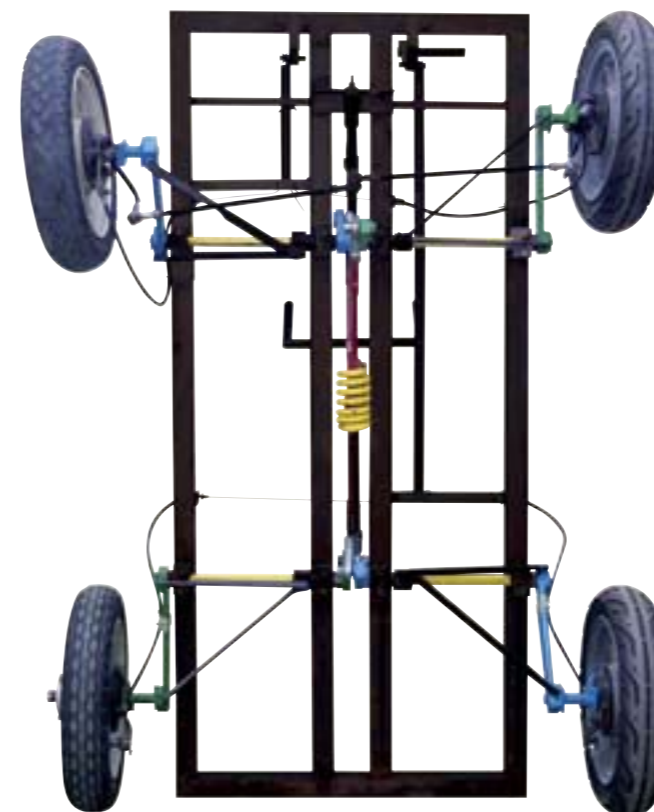
En el modelo mecánico básico podemos ver la idea, la rueda superior derecha queda enlazada con la inferior izquierda (en verde) al igual que las otras dos (en azul). El muelle central actúa de suspensión para el conjunto.
