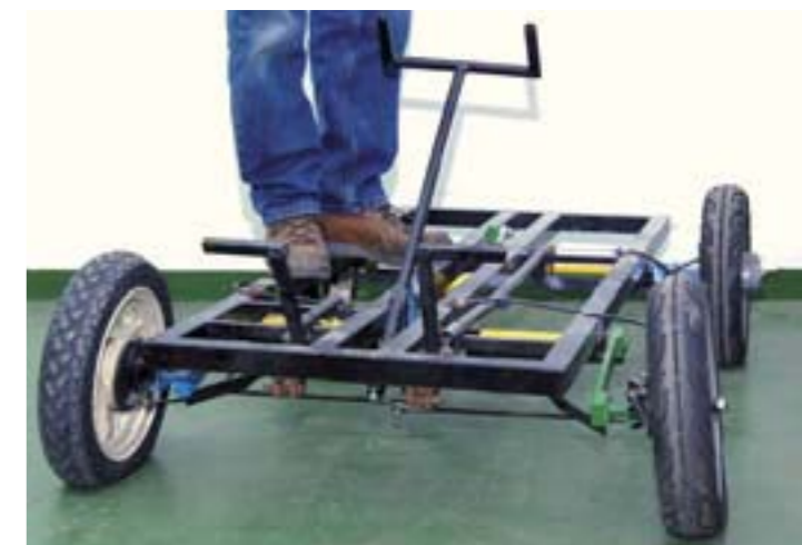
Cargar el peso en un lateral provoca que el conjunto baje plano, el sistema hace repercutir el peso a todo el conjunto, lo que evita inclinaciones laterales. Aplicado al ATV, evita en parte la tendencia al vuelco, tanto por la inercia como por el desplazamiento del cuerpo del piloto.
