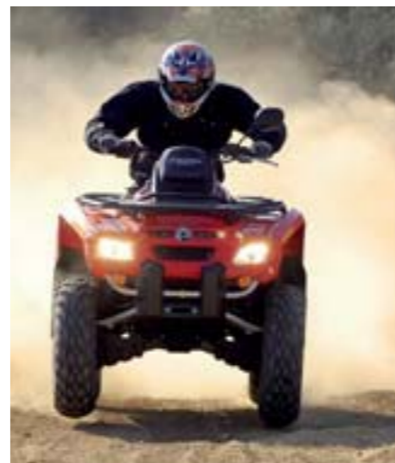
Tanto en la aceleración como en la frenada, el ATV tiende a actuar plano, es más difícil levantar o clavar el morro.
