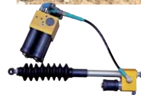
El secreto del conjunto radica en el dispositivo central. A través de las nuevas válvulas, visibles junto a las tomas de los latiguillos, se permite afinar los reglajes e incorporar nuevos, algo reservado a los especialistas. Los colores de las tomas sirven para guardar el orden con sus correlativos amortiguadores.
