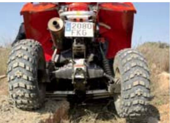
Cuando tenemos una rueda al aire, el sistema repercute la fuerza entre el resto, lo que permite mantener el ATV más plano que con un sistema convencional.
