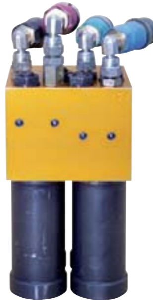
El secreto del conjunto radica en el dispositivo central. A través de las nuevas válvulas, visibles junto a las tomas de los latiguillos, se permite afinar los reglajes e incorporar nuevos, algo reservado a los especialistas. Los colores de las tomas sirven para guardar el orden con sus correlativos amortiguadores.
